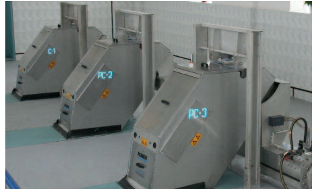
Anwendung HUBER Stufenrechen STEP SCREEN® SSF in Russland: Ausschwenkbar im Gerinne ohne Entfernung der nachgeschalteten HUBER Waschpresse und Trogförderschnecke.
