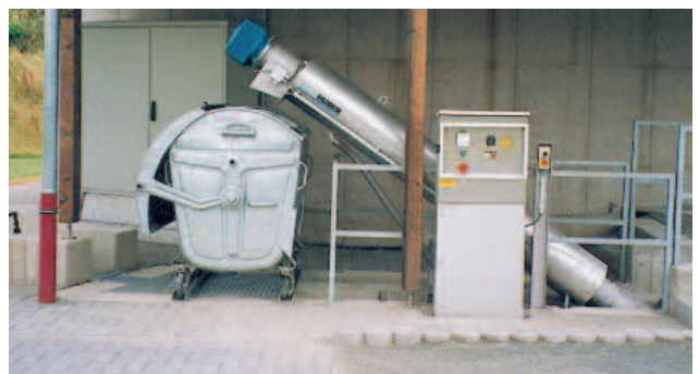
HUBER Siebschnecke ROTAMAT® Ro9: Die preisgünstige Lösung für kleine Abwassermengen
