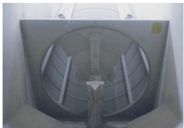
HUBER Siebanlage ROTAMAT® STAR liquid mit gefaltetem Siebkorb ermöglicht um bis zu 30 % höhere Durchsatzleistung bei Lochweiten von 1 / 1,5 / 2 mm.
