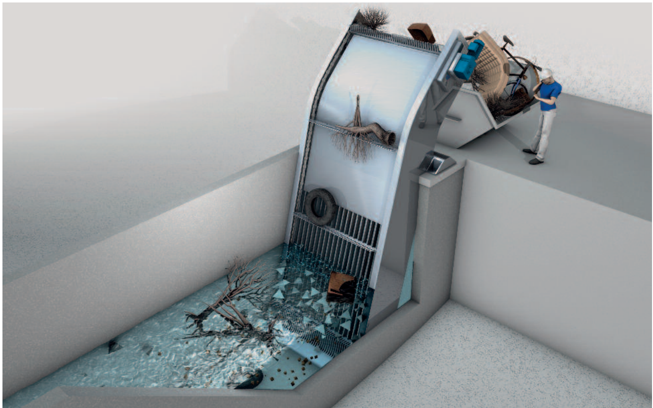
Robuste Rechentechnik für die Grobstoffentnahme mit großer Aufnahmekapazität der Rechenharken
