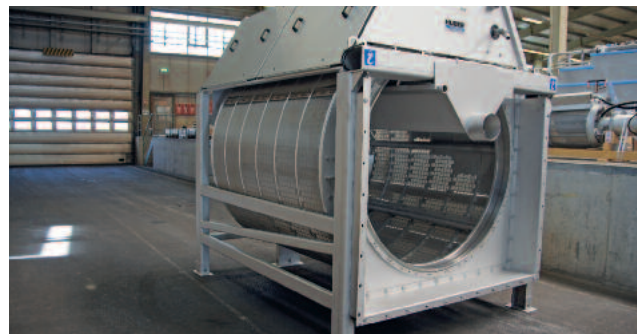
HUBER Trommelsieb LIQUID mit 1 mm Lochdurchmesser. Siebkorb in gefalteter Version für höchste Abscheide- und Durchsatzleistungen.
