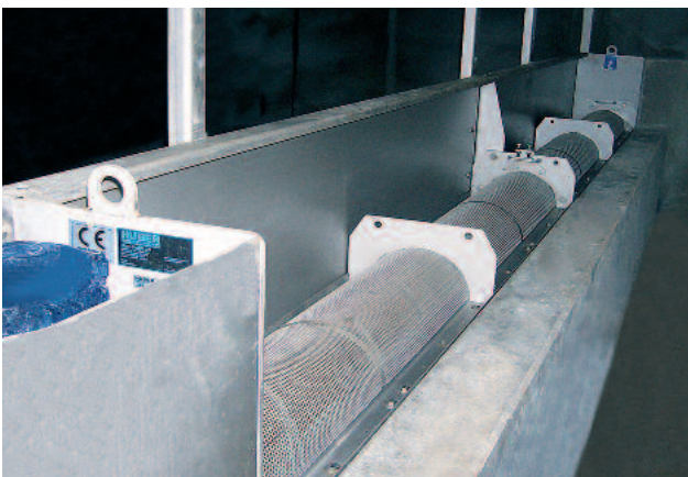
Ablaufseitige Ansicht der HUBER Siebanlage ROTAMAT® RoK2
